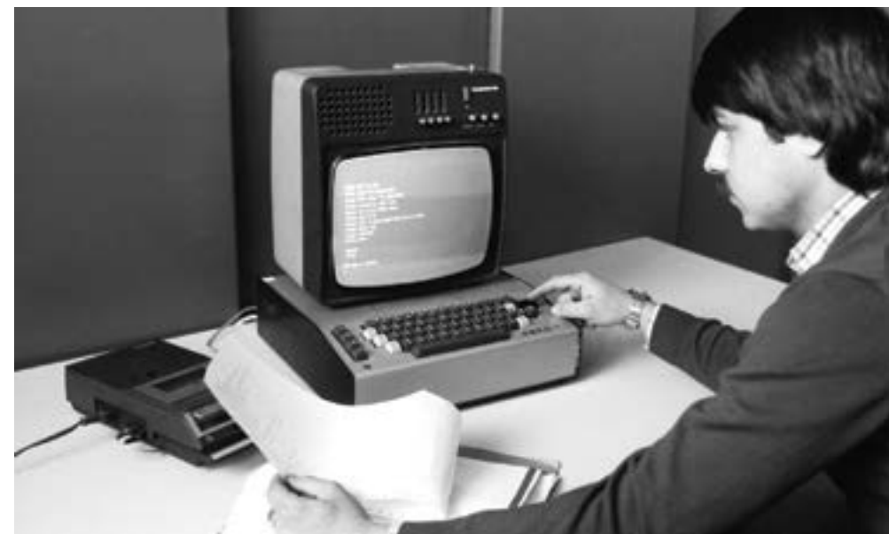
София, 19 януари 1982 г. ИМКО-1 – първият български персонален компютър, създаден от специалистите на Института по техническа кибернетика и роботика към БАН. Построен на базата на микропроцесор „Интел-8080“ върху една голяма печатна платка, компютърът разполага с клавиатура за ръчно въвеждане на данни. Нужната информация се получава върху екрана на обикновен черно-бял телевизор, а като периферна памет на магнитна лента се използва обикновен касетофон. Към компютъра може да се включат печатачо и други устройства. Снимка: Живко Ангелов, БТА
