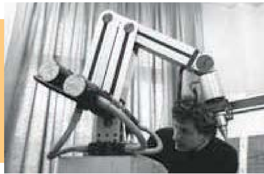
София, 8 януари 1990 г. В секцията по „Роботика и мехатроника“ на ИМБМ-БАН н.с. Любомир Марков използва антропоморфния робот „АРО“ с пет степени на свобода за изследователски цели. Снимка: Димитър Колакаков, БТА
